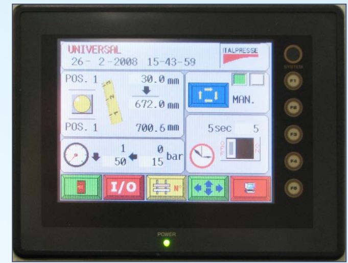
Interfaccia computerizzata per il controllo assi "TS/500" 'Touch-screen' operator interface TS/500
