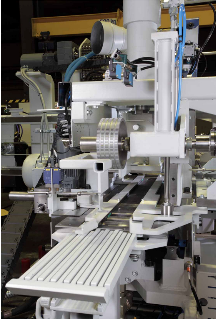
Nouveau : zone d'entrée avec table dentelée
