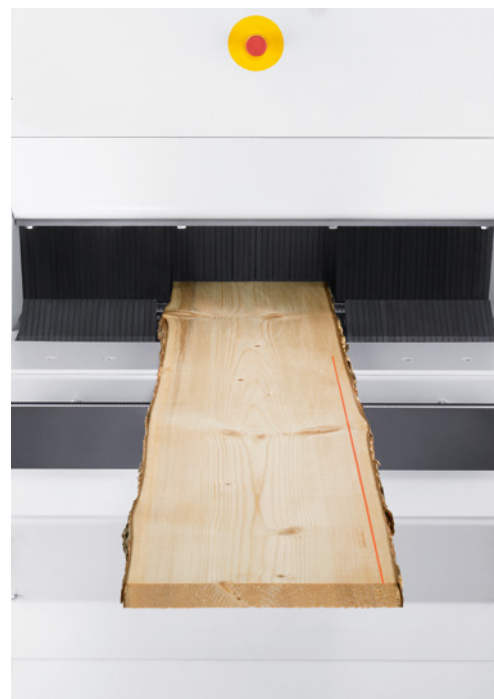
Laser pour visualiser le trait de scie: voir ce qui va être scié
