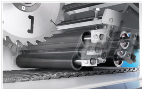
Réglage électrique en hauteur du caisson presseur: grand confort de manipulation
