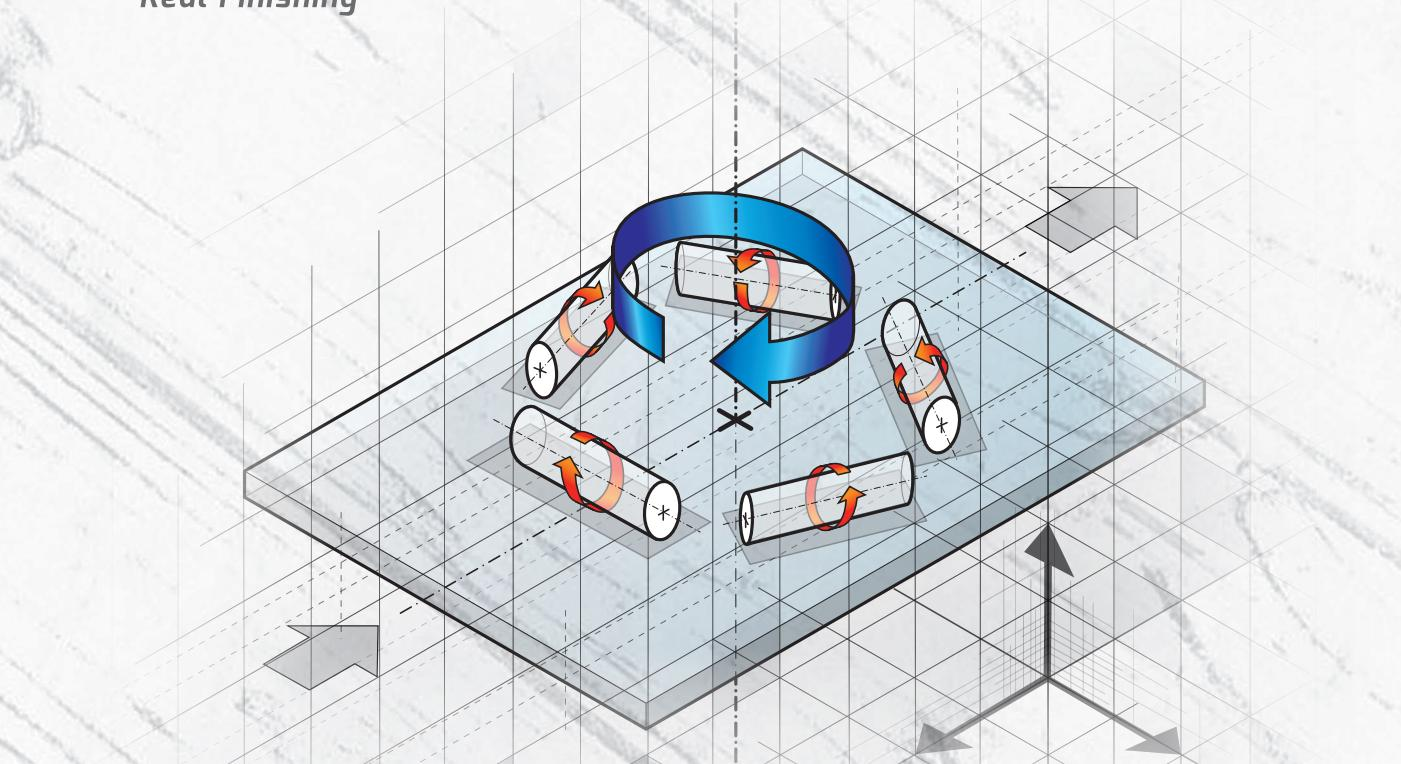
Grafica della dinamica di lucidatura. Il sistema ad angolazione variabile permette la lucidatura uniforme su tutta la superficie
