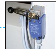
Fincorsa apertura piano Fincourse ouverture presse Final de carrera apertura plato móvil
